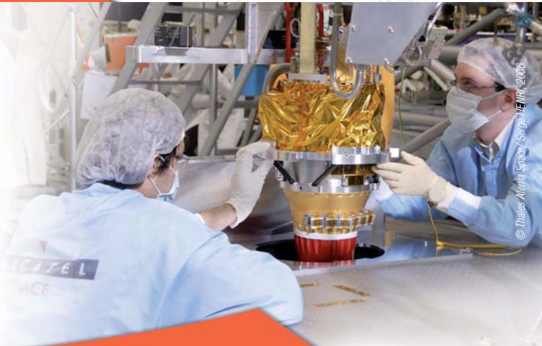
Intégration de l'instrument HFI sur le satellite Planck chez Thalès Alenia Space.
