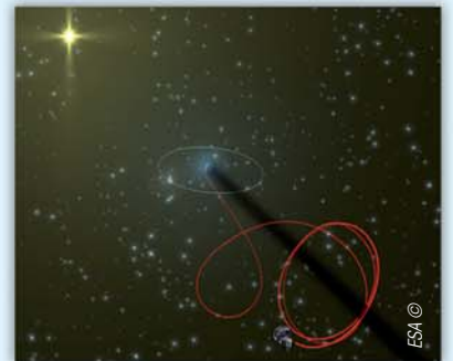
Planck suit une trajectoire optimisée pour rejoindre en 3 mois environ le point de Lagrange L2 situé à 1.5 millions de km de la Terre.
