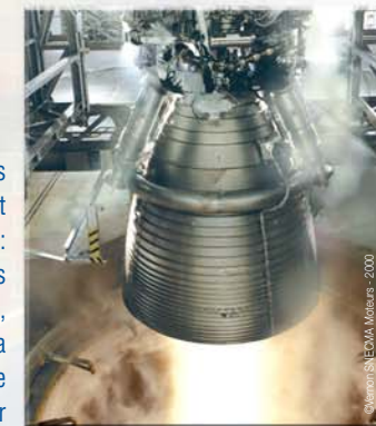
Mise à feu du moteur Vulcain 2 lors des essais chez Snecma Moteurs
